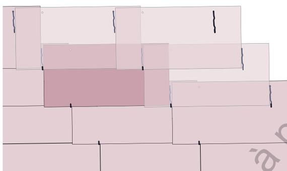
Fig. 4/104: Pose horizontale avec ardoises en fibres-ciment
